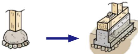
玉石基礎を鉄筋コンクリート造の布基礎に改修
