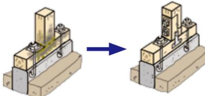
玉石基礎は、鉄筋コンクリート造の布基礎に改修し、土台を載せアンカーボルトで締め付ける
