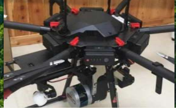
レーザーセンサー 詳細な地形データを取得
