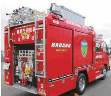
ポンプ付救助工作車 (写真は、消防署南分署に配備されている車両)
