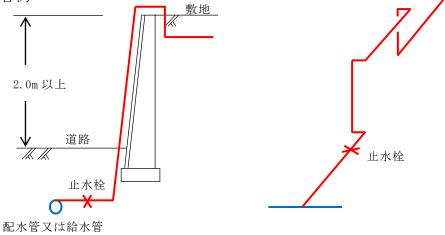
ア 水路・河川横断、橋梁添架等露出配管する場合は、外部からの衝撃及び凍結の防止をするため、必要な防護措置を施すこと。
