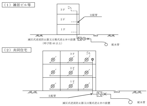
(8) 直結増圧式の場合は、立ち上がり管の最頂部等の適切な場所に停滞する空気を排出する機能と断水時等における負圧解消のための吸気機能を併せ持った吸排気弁を必要に応じて設置すること。
