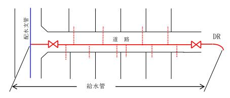
ただし、道路内に当該道路と平行に布設(設置)された口径 75 mm以上の給水管(鋳鉄管)については、その所有権を管理者に譲渡した場合は、配水管となる。
