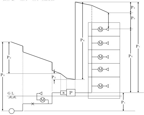
Po: 配水管圧力【設計水圧: 給水水圧調査による】
