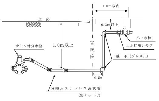
イ) 不断水割丁字管使用による分岐 (φ 40 mm)
