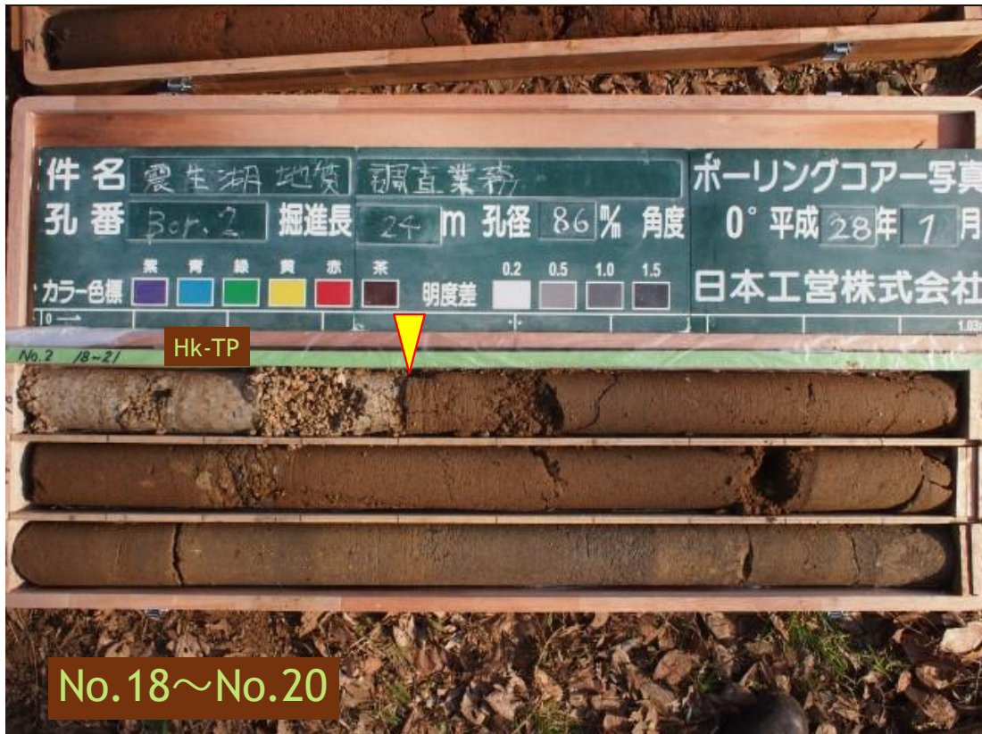
ボーリング資料 △印が推定滑り面
