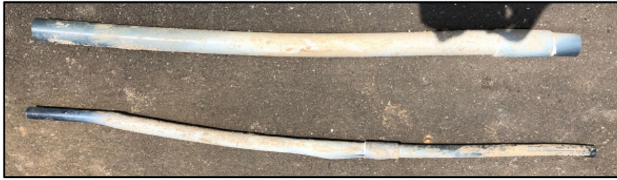
図 3-7 給水管の変形、破損
