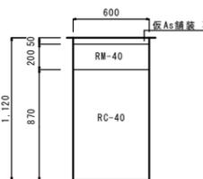
④ 標準掘削断面図
